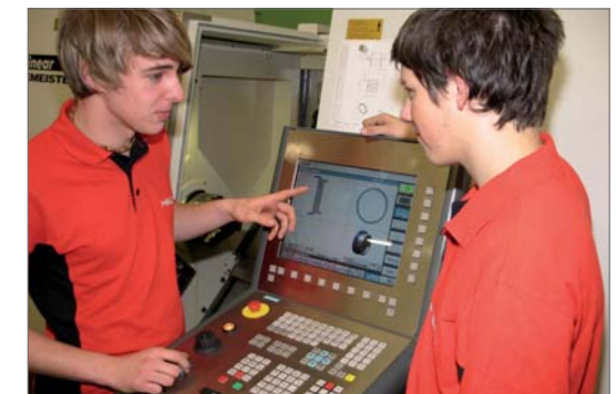
CNC-Programmierung an einer 4-Achsen-Drehmaschine
