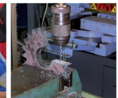
Bohrung für die Befestigung
