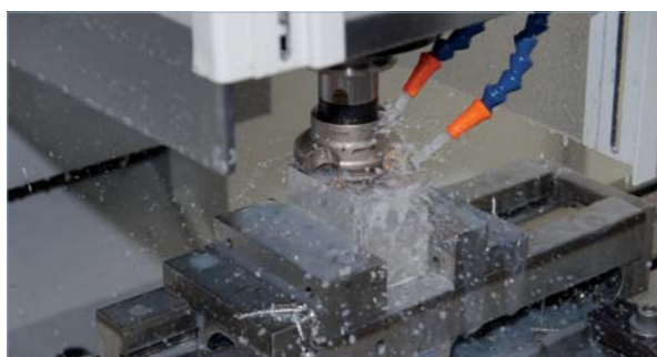
Formatfräsung Pyramide auf einer konventionellen Fräsmaschine
